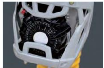
Marco de protección del motor con envoltura completa
